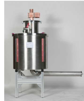
Kombinierte Stromzuführung inklusive Kühlung
